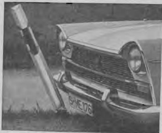
Zwischen dem Anke-Straßenleitpfosten und dem Pfostenfuß gibt es keine Hohlräume! Staub, Split, Wasser, aber auch Eis und Schnee ändern nichts an der einfachen, grundsoliden, korrosionsgeschützten und wartungsfreien Halterung. Der Pfostenkörper ist aus Holz, wetterfest lackiert und ordnungsgemäß markiert. Für die Halterung und den Pfostenfuß (Verankerung) verwenden wir Stahl, der feuerverzinkt ist. Abmessungen und Ausführung im Rahmen der HLB.
