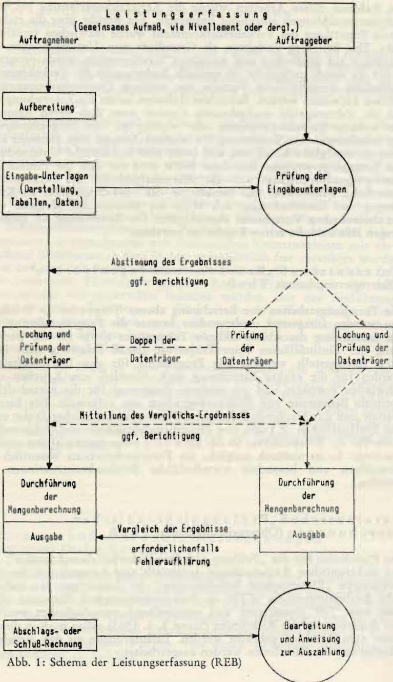
Abb. 1: Schema der Leistungserfassung (REB)
