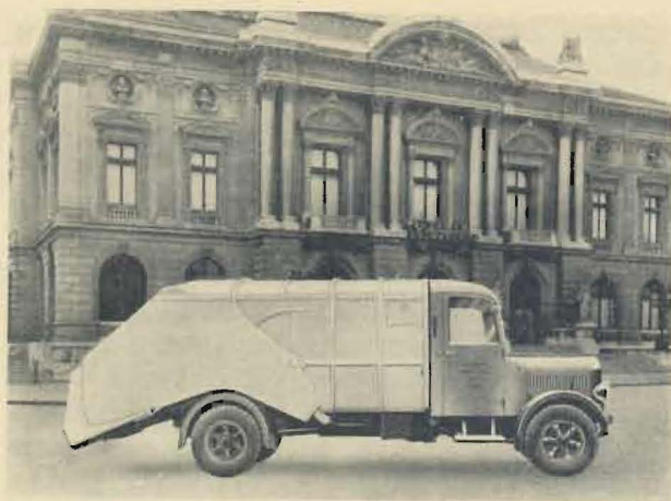
Abb. 1. Grossraum-Kehrriechtswagen System „Ochsner“, auf Saurer-Chassis mit Leichtmetall-Kastenaufbaute, in Verbindung mit Förder- und Pressvorrichtung. Inhalt: lose 10 m 3 ; gepresst 15–16 m 3 Kehrriecht.
