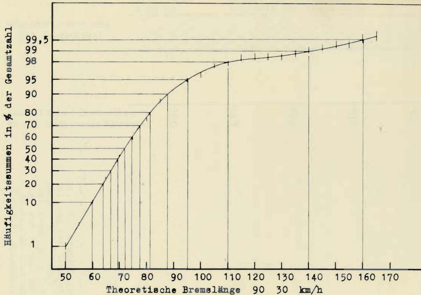
Bild 4. Empirische Häufigkeitsverteilung der theoretischen Bremslängen für eine Geschwindigkeitsminderung von 90 auf 30 km/h
