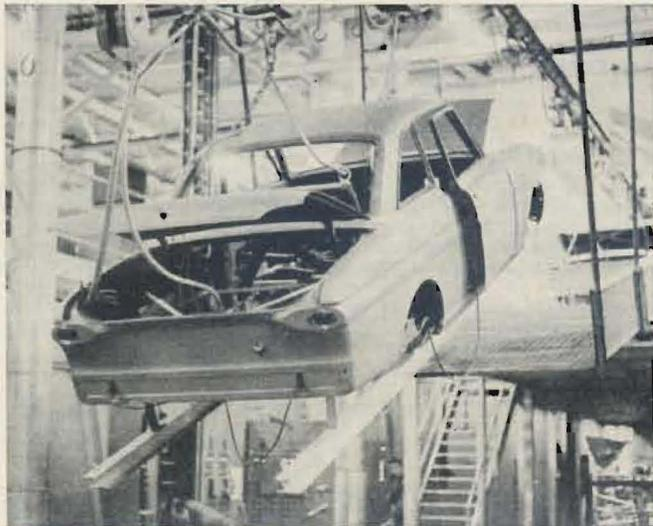
Bild 1. Mit Elektroden und Gleitschienen versehene Rohkarosserie auf dem Weg ins Electrocoating-Tauchbad bei Ford
