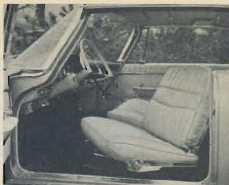
Bild 17. Ausschwenkbare Vordersitze bei Chrysler, Dodge und Plymouth gewähren bessere Einstiegsmöglichkeit.
