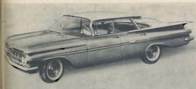
Bild 15. Chevrolet Impala Sport Sedan; Typisch für die neuen GM-Modelle sind die sphärisch gewölbten Windschutzscheiben, die sich bis in die Dachlinie hineinziehen.
