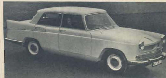
Bild 20. Der neue Austin A 55 Cambridge mit einer von Farina entworfenen Karosserie; 1,5-l-Motor, 53 PS bei 4350 U/min; \kappa = 8,3 .
