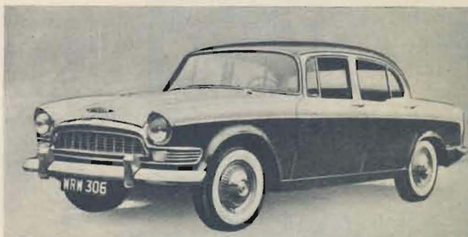
Bild 19. Humber Super Snipe; 6 Zylinder; 2,6 Liter; 112 PS bei 5000 U/min.
