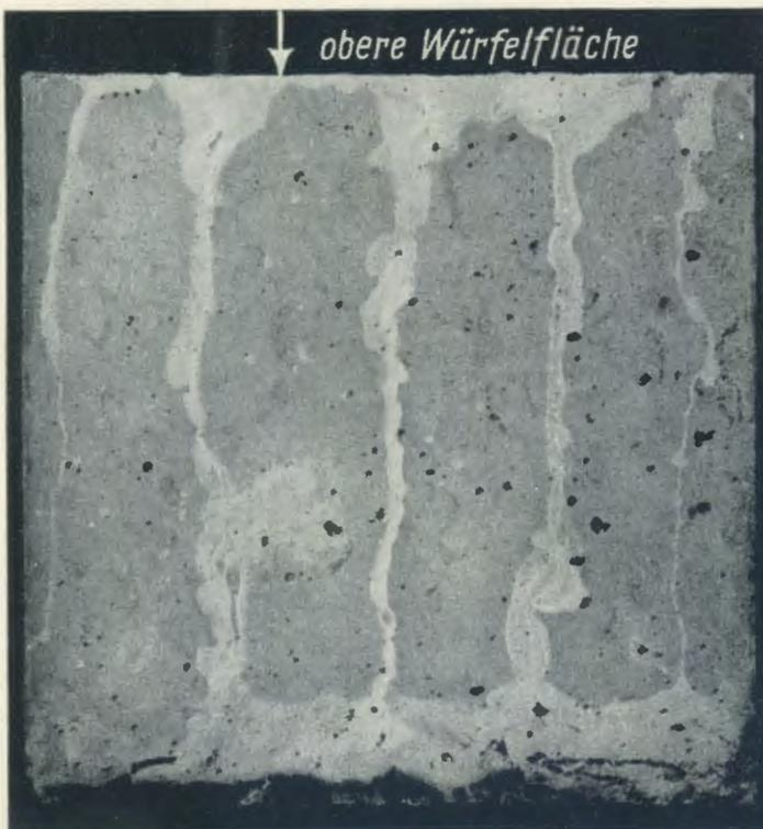
Bild 7 Ausblühungen nach dem Rieselversuch auf der Seitenfläche eines Würfels aus Beton B 450
